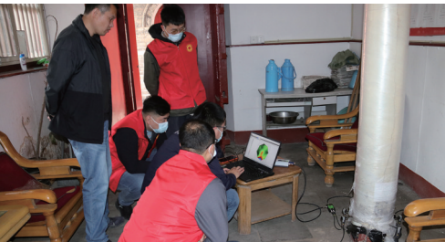
定期巡查中使用应力波测定仪监测礼器库后金柱受白蚁侵蚀影响程度
