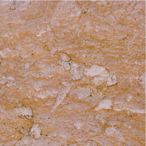
三星堆遗址月亮湾城墙剖面粉状剥落病害
