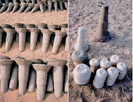
图3 尼日尔比尔马筒形盐模及脱模的盐柱
